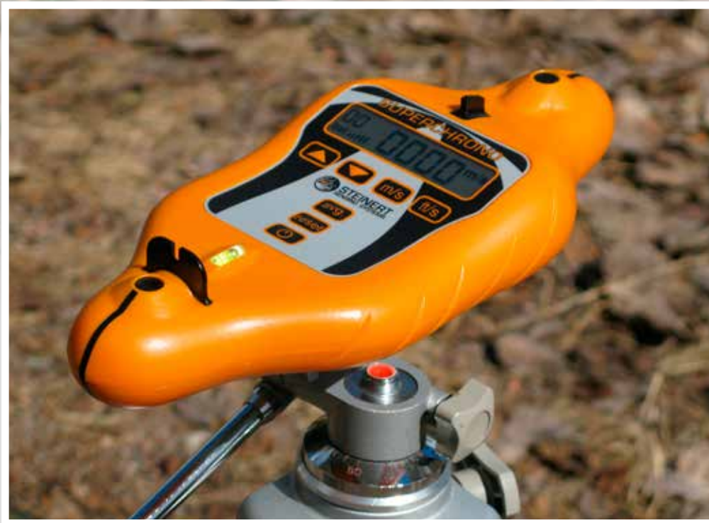
SuperChronon kummassakin päässä on musta nappimainen mikrofoni, joka tunnistaa ylääänisen luodin aiheuttaman ääniäallon. Laitteen päällä on myös avotähtäimet oikein linjaamista varten.
