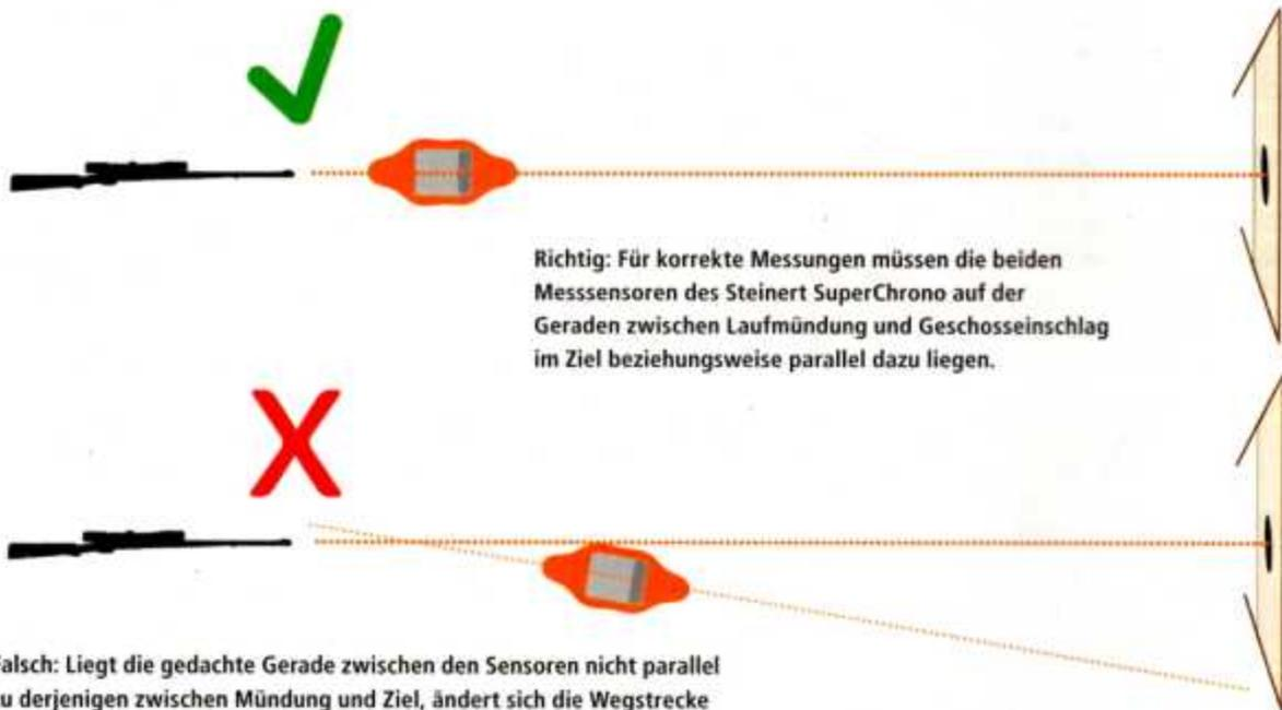
**Richtig:** Für korrekte Messungen müssen die beiden Messsensoren des Steinert SuperChrono auf der Geraden zwischen Laufmündung und Geschosseinschlag im Ziel beziehungsweise parallel dazu liegen.
