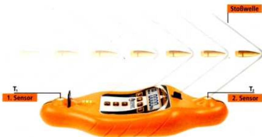
Die Grafik des Herstellers zeigt die vom Geschossbug ausgehende, permanente Machsche Stoßwelle bei Überschallgeschwindigkeit. In Schussrichtung (X-Achse) ist diese genauso schnell wie das Projektil. Die Welle läuft über die beiden, im Abstand von 200 mm liegenden Sensoren, die das Drucksignal in ein elektronisches umwandeln. Das Gerät misst die Zeit, welche die Welle von Sensor zu Sensor benötigt und errechnet daraus die Geschossgeschwindigkeit.
