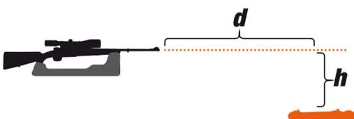
muss man dafür sorgen, dass der Abstand der Mündung zum Messgerät ( $d$ ) größer ist als die Höhe ( $h$ ) vom Messgerät hoch zur Geschossflugbahn (siehe Illustration unten)
